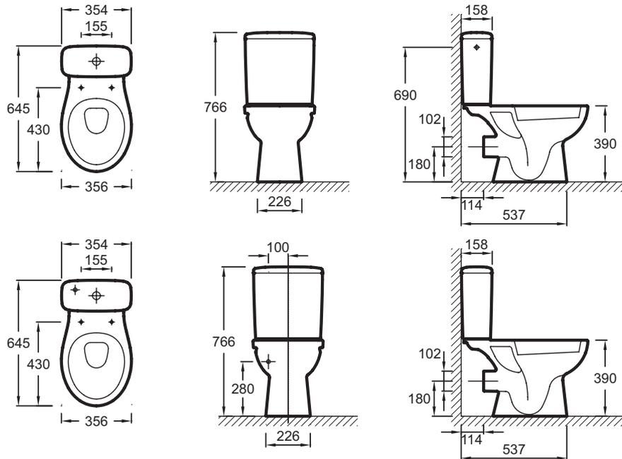
Descriptif CCTP : Cuvette sortie horizontale, 64,5 x 35,6 cm. UJD101. Collection : PATIO. Dimensions : 64,50 x 35,60 cm. Poids : 21,1 kg. Matériau : Céramique. Type d'installation : Au sol. Consommation d'eau : Standard 3/6 L. Hauteur : Standard. Type de bride : Ouverte (traditionnelle). Sortie horizontale.
