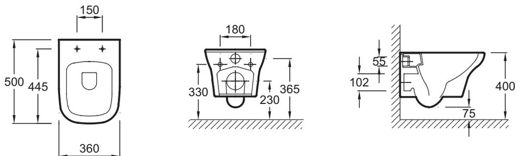
Descriptif CCTP : Cuvette suspendue SANS BRIDE. EDM102. Collection : VOX. DIMENSIONS : 50 x 36 cm. POIDS : 20,8 kg. MATÉRIAU : Céramique. TYPE D'INSTALLATION : Suspendu. CONSOMMATION D'EAU : Standard 3/6 L. TYPE DE BRIDE : Sans bride. BRIDE : Sans bride. PRODUIT INCLUS : (abattant non inclus). ABATTANT : Non inclus. GARANTIE DE LA CÉRAMIQUE : 10 ans. FIXATION DE LA CUVETTE : Invisibles.
