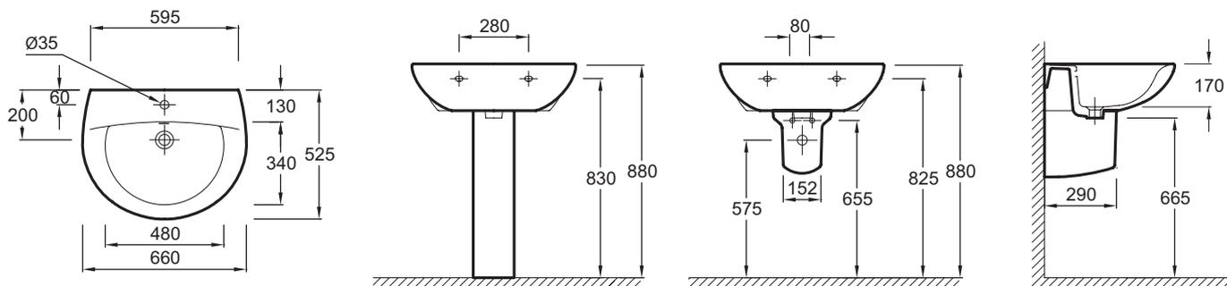
Descriptif CCTP : Lavabo 66 cm. E1998. Collection : PATIO. DIMENSIONS : 66 x 52,50 cm. POIDS : 17,5 kg. MATÉRIAU : Céramique. TYPE D'INSTALLATION : Autoportant. FIXATIONS : Par 2 goujons non fournis. PERCEMENT ROBINETTERIE : Percé 1 trou pour robinetterie. CONFIGURATION : STANDARD. TROP-PLEIN : Avec trou de trop plein. PRODUIT INCLUS : (robinetterie non incluse).
