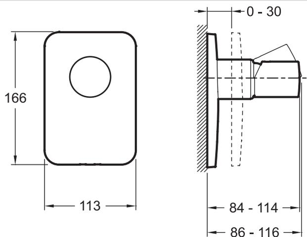
Descriptif CCTP : Mitigeur mécanique à encastrer - sans inverseur - façade et levier Toobi. E98707. Collection : TOOBI. POIDS : 1,8 kg. TYPE D'INSTALLATION : Encastré. NORMES ET RÉGLEMENTATIONS : ACS : 10 ACC LY 004.
