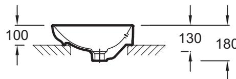
Descriptif CCTP : Vasque à poser 56 cm. EVI102. Collection : NOUVELLE VAGUE. DIMENSIONS : 56 x 40 cm. POIDS : 9 kg. MATÉRIAU : Céramique. TYPE D'INSTALLATION : Posé. PERCEMENT ROBINETTERIE : Percé 1 trou. TROP-PLEIN : Avec trou de trop plein. PRODUIT INCLUS : (robinetterie non incluse). ROBINETTERIE CONSEILLÉE : Nouvelle Vague. INFOS COMPLÉMENTAIRES : (robinetterie non incluse).
