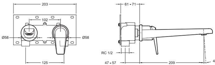
Descriptif CCTP : Mitigeur lavabo. E97358. Collection : AVID. POIDS : 3,8 kg. TYPE D'INSTALLATION : Mural. NORMES ET RÉGLEMENTATIONS : ACS : 14 ACC LY 511. TYPE : Mitigeur. DÉBIT (L/MN SOUS 3 BARS) : 5 l/mn. SAILLIE DU BEC (MM) : 209. RACCORDS : Corps à encastrer (G1/2). MÉCANISME : Cartouche à disques céramique. TYPE D'INSTALLATION : 2 trous. GARANTIE MÉCANISME : 5 ans. GARANTIE FINITION : 25 ans pour le PVD nickel brossé. Sans bonde de vidage.
