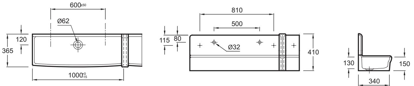
Descriptif CCTP : Lavabo 100 cm. EN290. Collection : DUO. DIMENSIONS : 100 x 36,50 cm. POIDS : 26,5 kg. MATÉRIAU : Céramique. TYPE D'INSTALLATION : Non autoportant, nécessite des supports muraux (non fournis). PERCEMENT ROBINETTERIE : Sans trou de robinetterie. CONFIGURATION : STANDARD. Lavabo mural en céramique.
