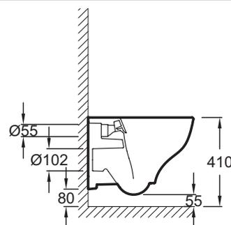
Descriptif CCTP : Cuvette suspendue compacte SANS BRIDE. EDF101. Collection : STRUKTURA. DIMENSIONS : 48 x 34 cm. POIDS : 19 kg. MATÉRIAU : Céramique. TYPE D'INSTALLATION : Suspendu. CONSOMMATION D'EAU : 2,6/4 L et 3/6 L. HAUTEUR : Confort. BRIDE : Sans bride. PRODUIT INCLUS : (abattant, bâti-support et plaque de commande non inclus). ABATTANT : Non inclus. GARANTIE DE LA CÉRAMIQUE : 10 ans. CONDITIONNEMENT : Un seul colis.
