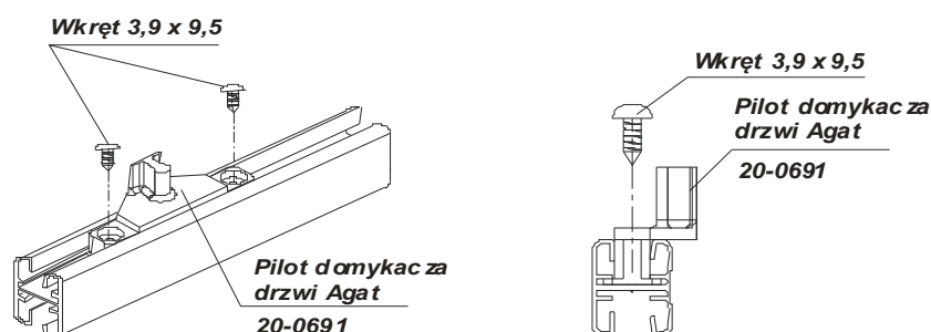
2a Fixation de la platine à la traverse haute
